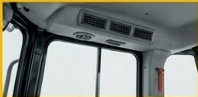
2. Climatización: Sistema de Aire Acondicionado Avanzado.
